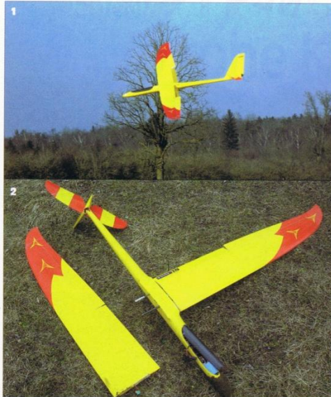
1 Bei Windstille ist eine größere Butterfly-Stellung wünschenswert, mit den oben angeschlagenen Wölbklappen fällt es schwer, den „Espresso“ komplett runterzubremsen. 2 Beim Hahnenmoos-Trainingslager an der Teck fiel der „Espresso“ einer Doppelbelegung zum Opfer. 3 Der zweite „Espresso“ wurde direkt mit den Verbesserungen aus dem ersten Modell aufgebaut und wird bis heute geflogen.
