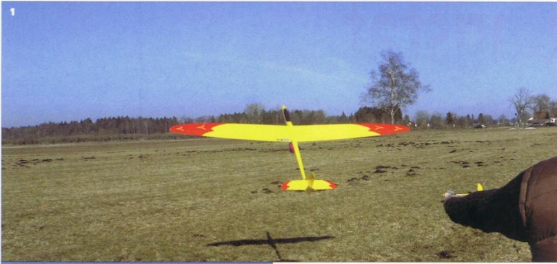
1 Zum Erstflug wurde mit dem F3B-Gummi von EMC-Vega gestartet. Die Klappen auf Startstellung sollten helfen Druck auf das Modell zu bringen. 2 Das Profil zeigt Stärke im Gleiten. Auch bei widrigem Wetter bleibt das Modell lange in der Luft.
